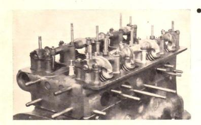
PUSH ROD OPERATION OF VALVES VIA LIGHT ROCKER
